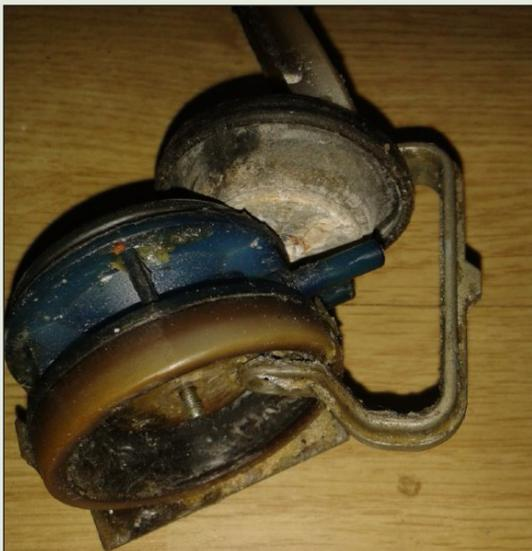
Bild links: Hier ist exemplarisch das Ergebnis einer undichten Vernietung aufgezeigt. Der Korpus ist völlig verdreckt. Eine Instandsetzung macht eigentlich keinen Sinn, da es sich schon damals als Fehlkonstruktion erwies.
